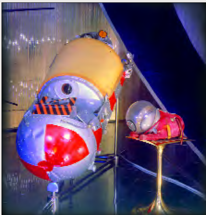
Катапультируемый контейнер второго космического корабля-спутника, выведенного на околоземную орбиту в 1969 г. с собаками Белкой и Стрелкой на борту. Скафандр для собак, совершавших полеты на геофизических ракетах в 1950-х гг.
