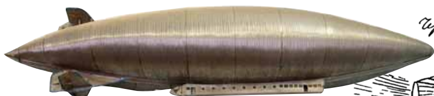
Модель цельнометаллического дирижабля конструкции К.Э. Циолковского
